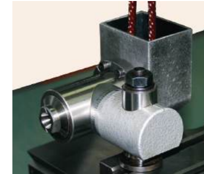
Appareil à meuler à courroie Pince B8
